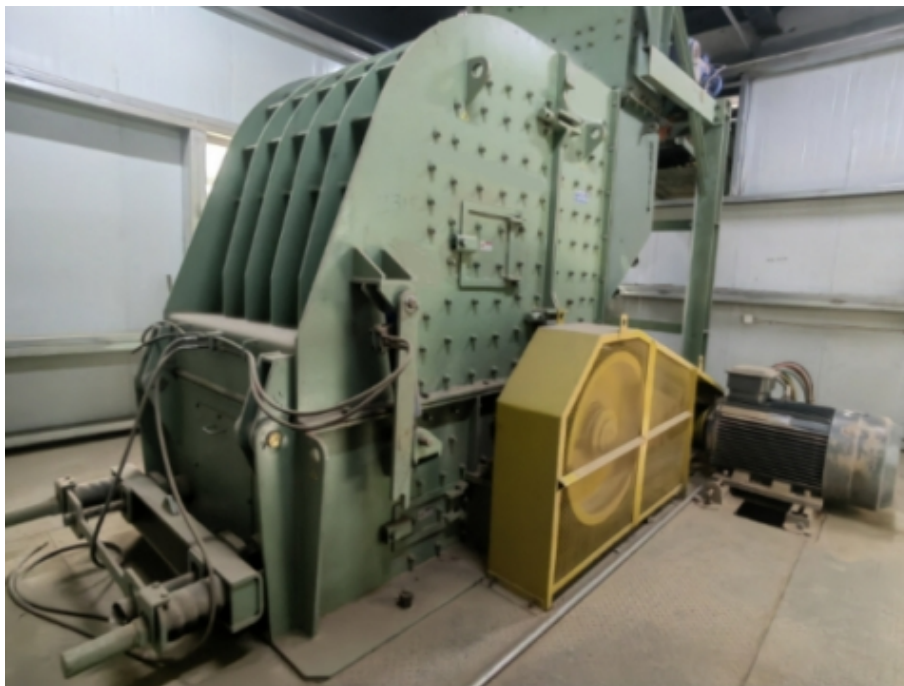
图 5-6 反击式破碎机装机图
