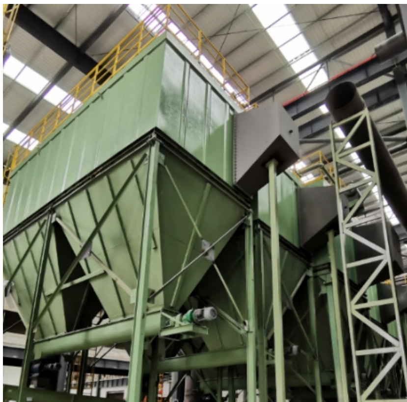
图 5-14 布袋除尘器装机图
