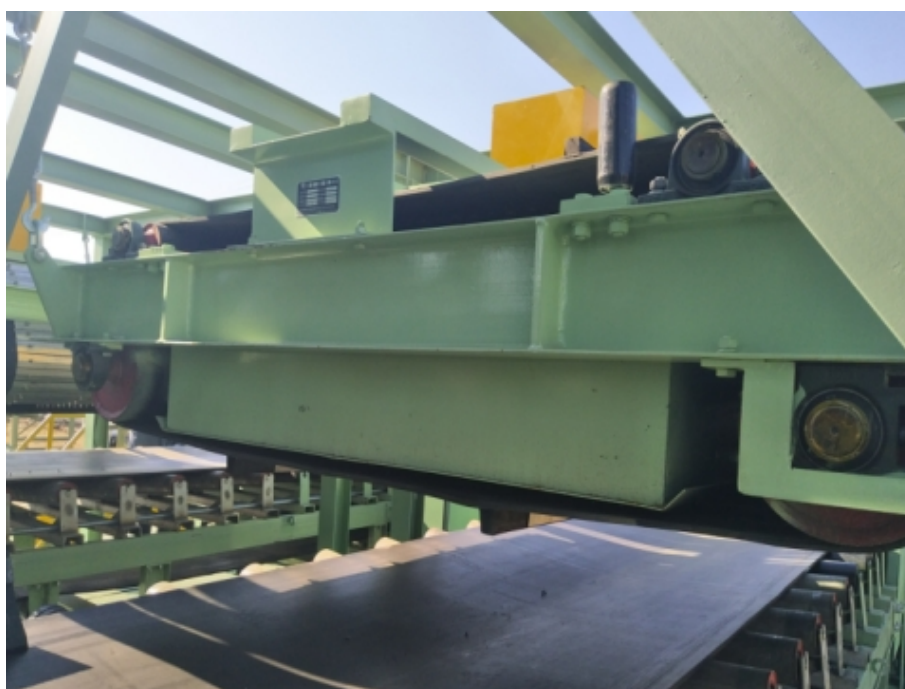
图 5-11 除铁器装机图
