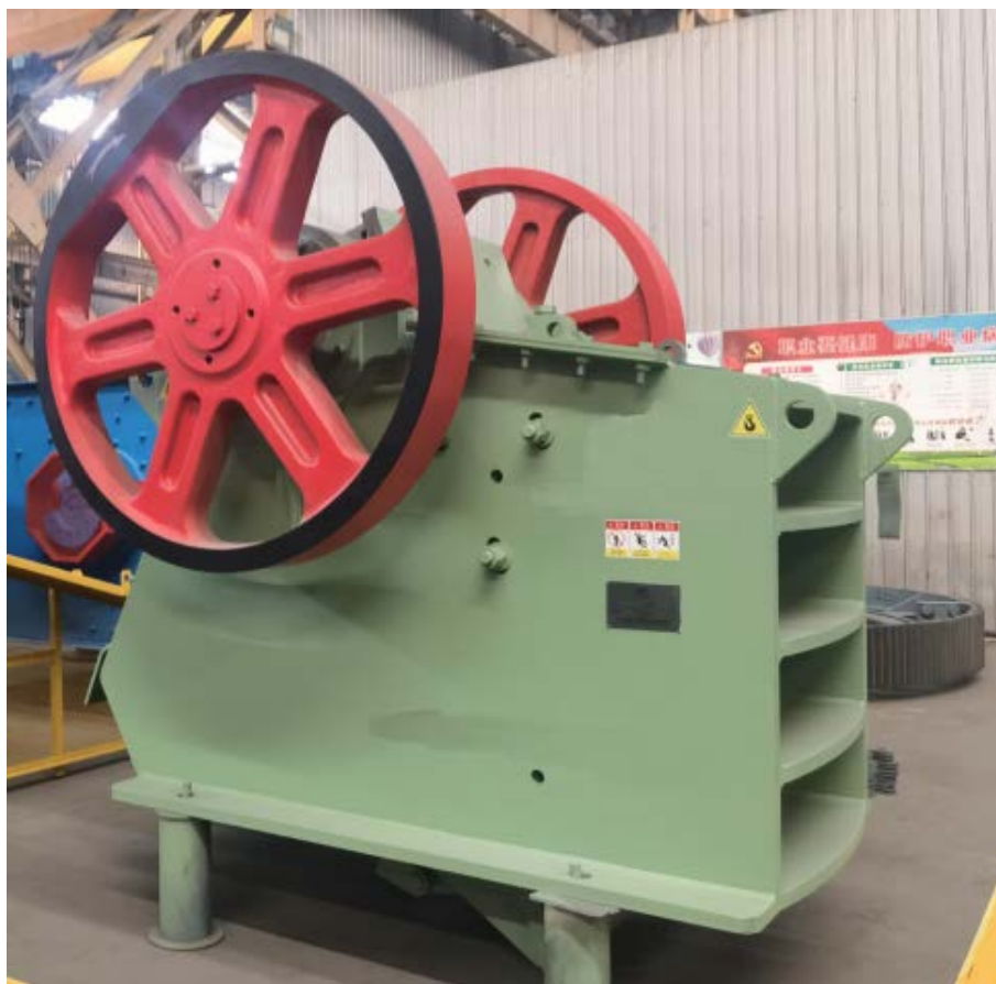
图 5-5 颞式破碎机装机图
