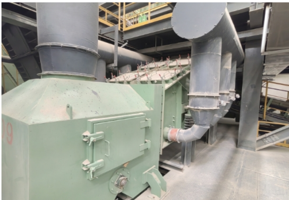
图 5-9 振动风选机装机图
