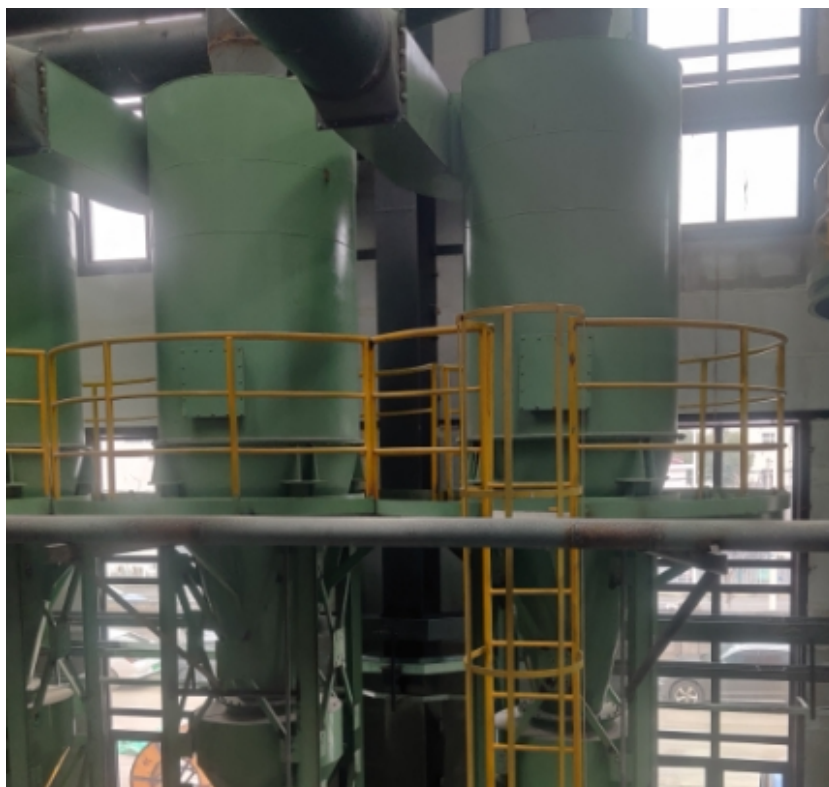
图 5-13 旋风除尘器装机图
