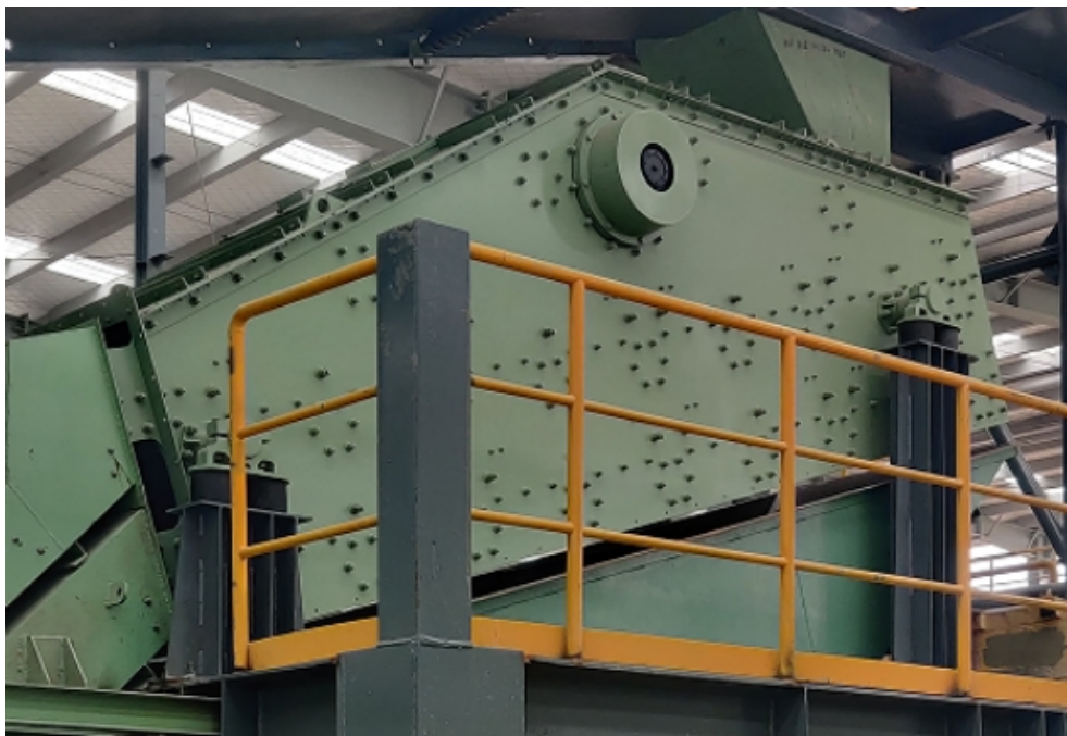
图 5-8 圆振筛装机图
