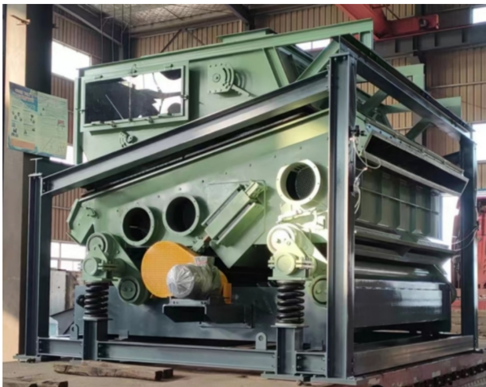
图 5-10 多质体分选机装机图
